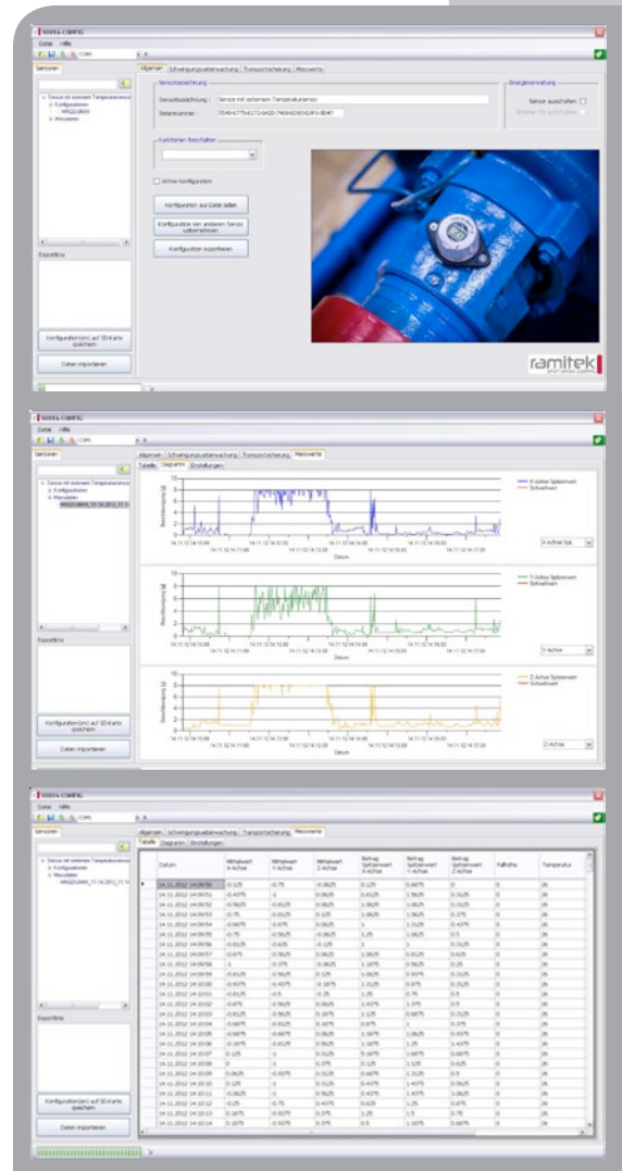
Die Monitoringsoftware 10816-CONFIG® - Parametrierung von Sensoren, Verwaltung und Analyse von Messdaten
