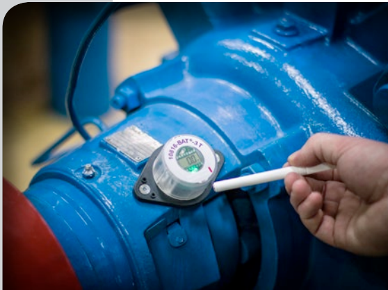
Parametrierung durch die integrierten Magnetschalter
