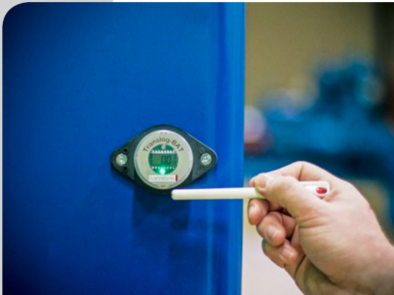
Einstellung durch die integrierten Magnetschalter
