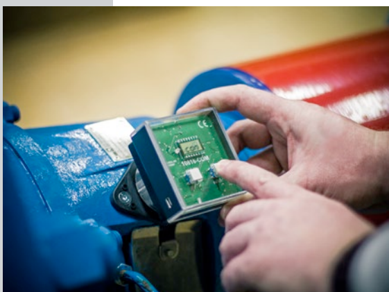
Das Kommunikationsmodul 10816-COM® überträgt Daten zwischen Sensor und PC.
